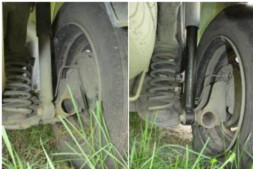
Slika 1: Primer amortizera zadnje osovine (Dacia): ne može se znati koliko je ostalo ulja u amortizeru na desnoj slici
