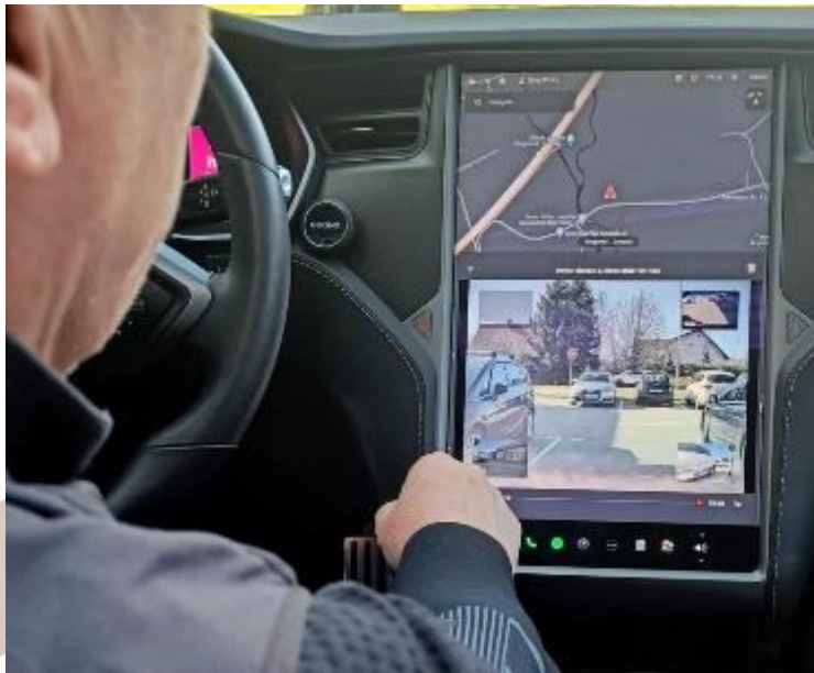
Slika 3: Fokus/rotacija glave potrebna za navigaciju kroz touchpad – rotacija za približno 15°.
