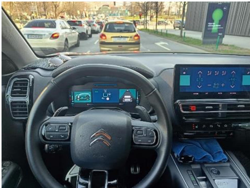
Slika 5: Centralna kontrola, glasovne komande ili dodatne funkcije kao što su komande na ekranu osjetljivom na dodir zahtevaju pogled do 20 stepeni udesno, sa ciljem da se obezbedi ispravan položaj komande i obezbeđivanje uspešne interakcije.
