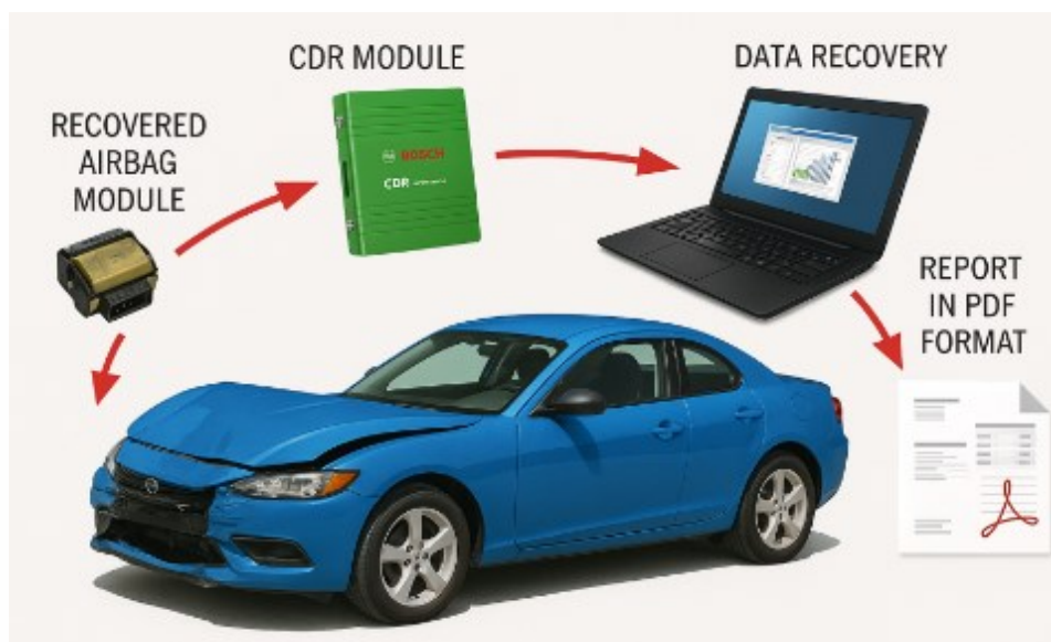
Slika 1. Proces očitavanja podataka iz EDR sistema vozila korišćenjem Bosch CDR alata.
