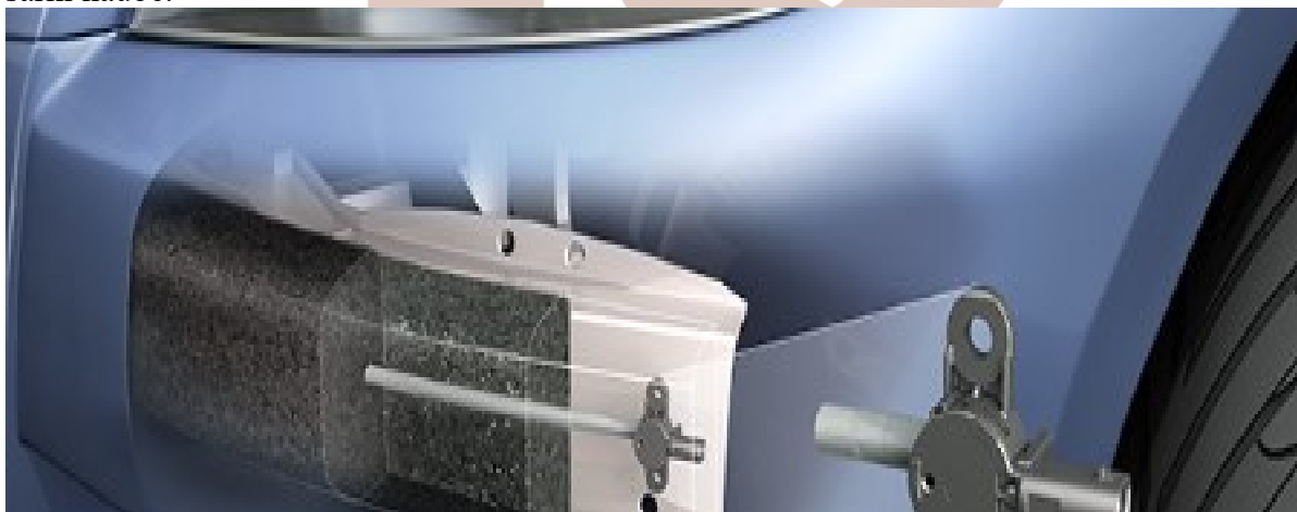
Slika 5: Senzor cevi za pritisak, integrisan u prednji spojler vozila- vir slike Bosch
