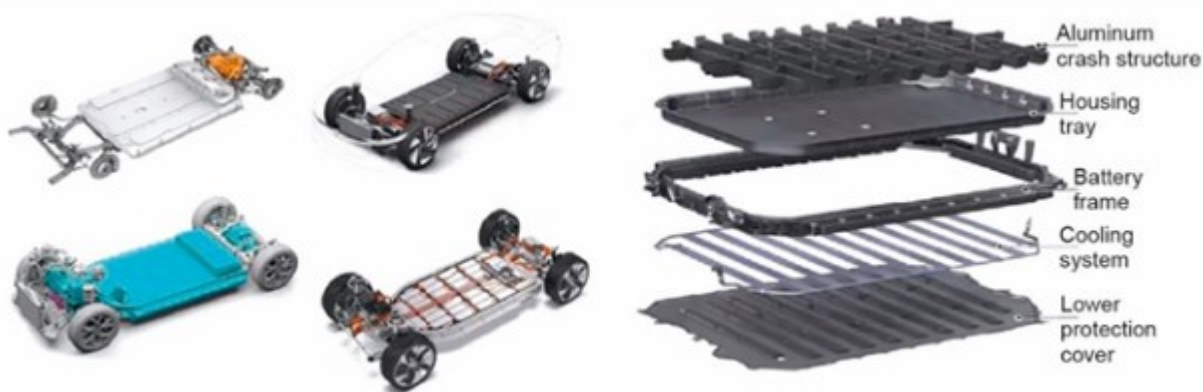
Слика 3. Конструкција каросерије различитих брендова електричних возила и структура кућишта батерије електричног возила [4]
